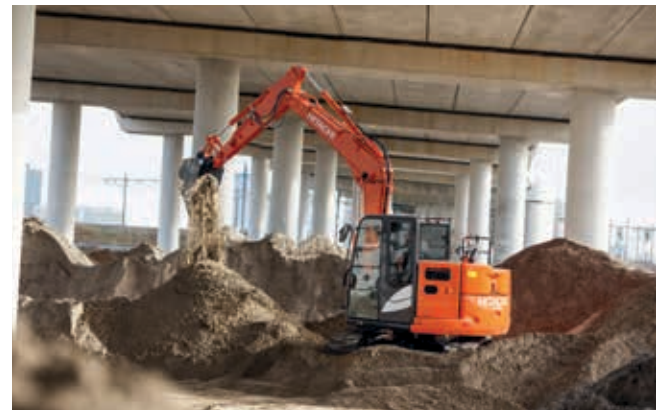
Dank des kleinen Heckschwenkradius ist der ZX85USB-6 ideal für Arbeit auf engem Raum.
