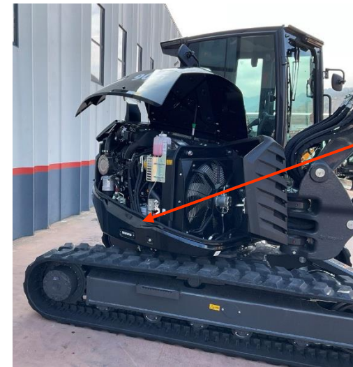
FAN DRIVE – Viskolüfter Kühlsystem (mit automatischer Invertierung )
