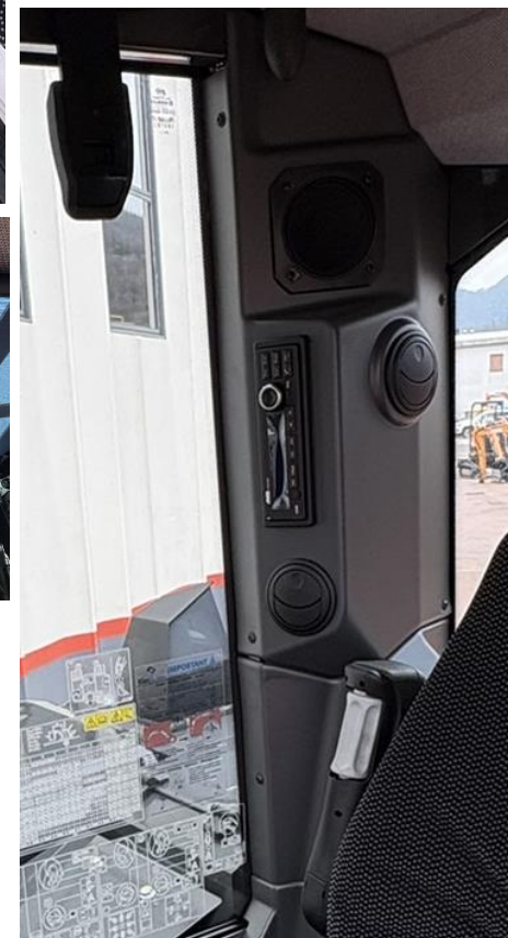
Sonnenrollo, Kleiderhaken Innenbeläuchtung, Bluetooth Radio mit Freisprechanlage (opt. DAB+) und etliche Lüftungseinheiten
