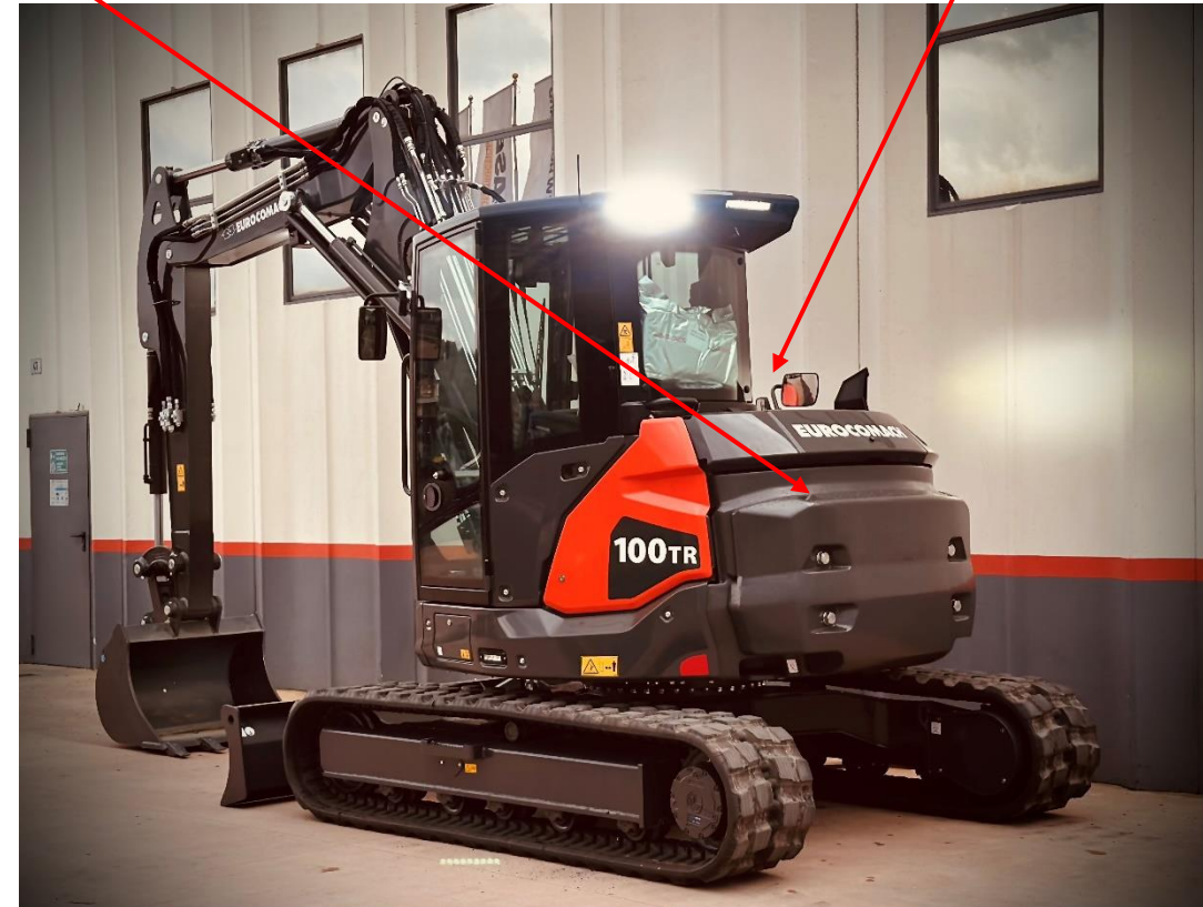
Zusatzheckgewicht 440 kg wird Innen im Rucksack verbaut (Serie bei 100 TR)
