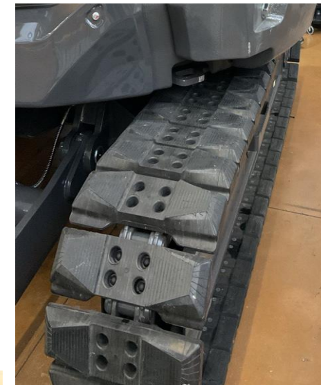
GEOGRIP BRIDGESSTONE (vulkanisierte Eisenketten direkt aufgeschraubt)
