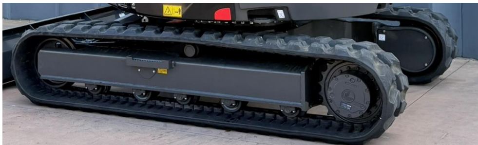
Gummiketten – mit durchgehender Kettenführung und einem Profil das immer zur Kettenmitte läuft – ein guter Standard auch im 10 Tonnenbereich
