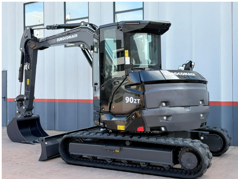
Gummiketten – mit durchgehender Kettenführung und einem Profil das immer zur Kettenmitte läuft – ein guter Standard auch im 10 Tonnenbereich
