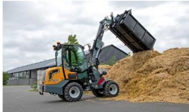
Der G2700 TELE HD und der G2700 TELE HD+ werden durch einen 50 PS-Motor von Kubota angetrieben, während der G2700E TELE als erster elektrisch angetriebene Teleskopradlader von TOBROCO-GIANT eingeführt wird. Die Modelle kombinieren die kompakte Bauweise mit einer maximalen Auskipphöhe von 3711mm, was die Hubhöhe um ca. 48% im Vergleich zum X-TRA-Hubgerüst erhöht.
