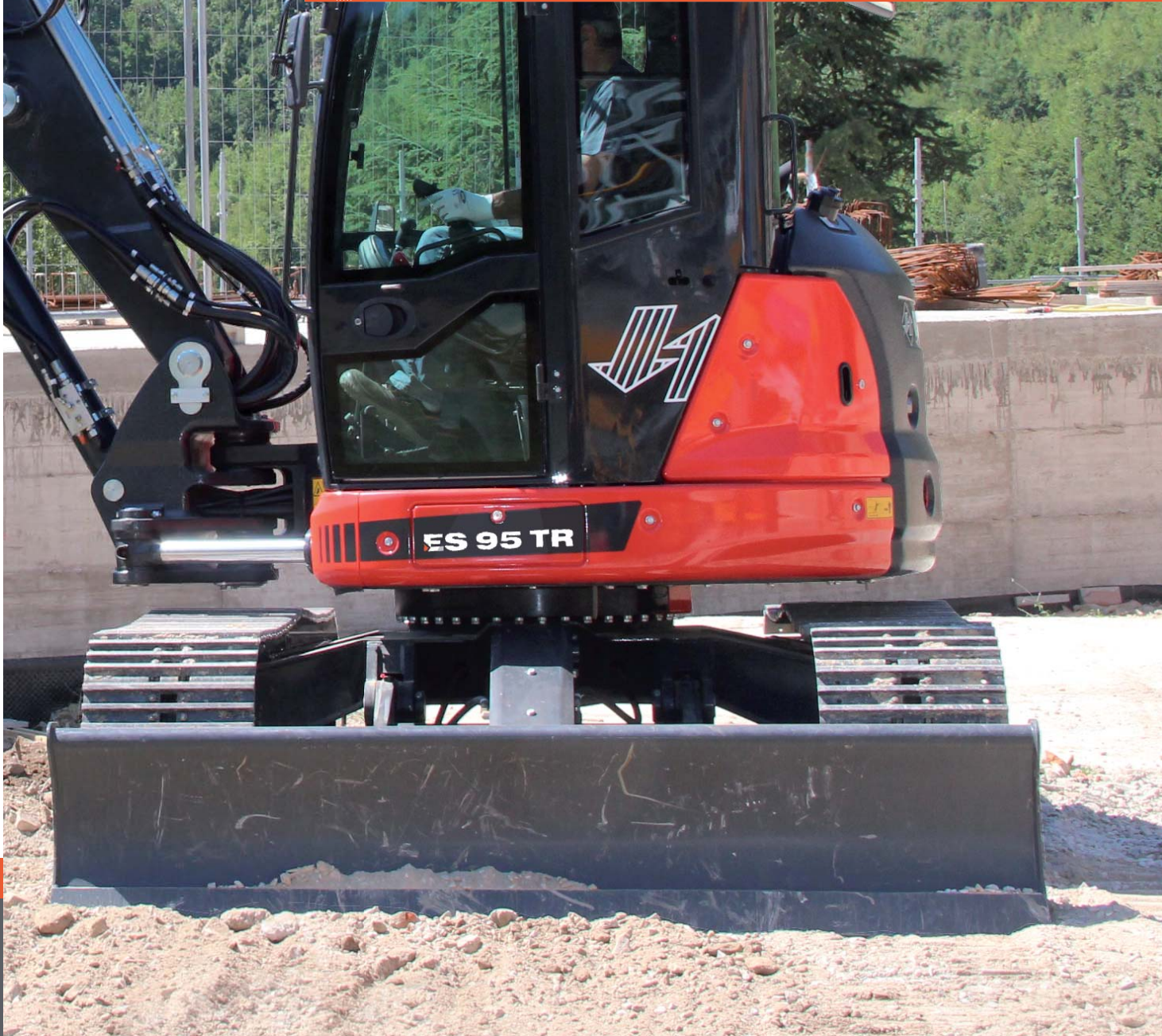
ES 95 TR - Maximale Leistung 63.2 PS - Maschinengewicht 10.220 kg
