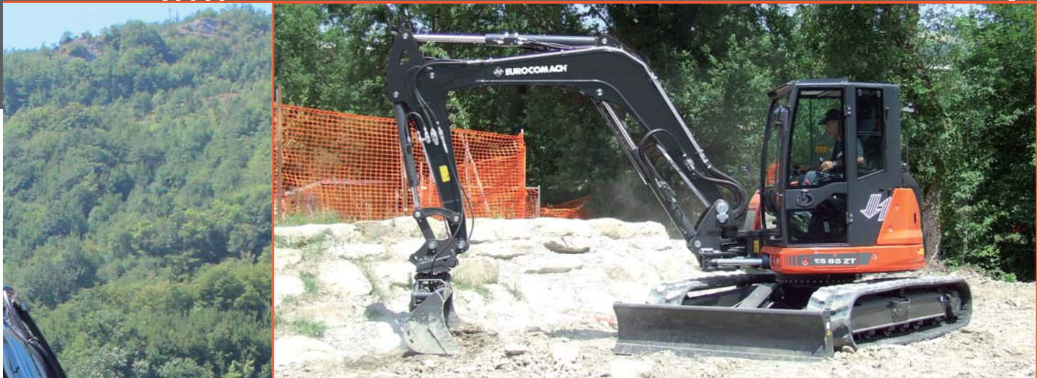
ES 85 ZT - Maximale Leistung 63.2 PS - Maschinengewicht 9.000 kg
