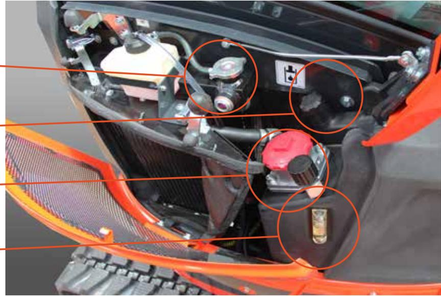
Alle Zugangspunkte für die täglichen Kontrollen und für die Eingriffe der ordentlichen Wartung sind in bestimmten Bereichen konzentriert, um eine Optimierung der Ausfallzeiten zu ermöglichen.
