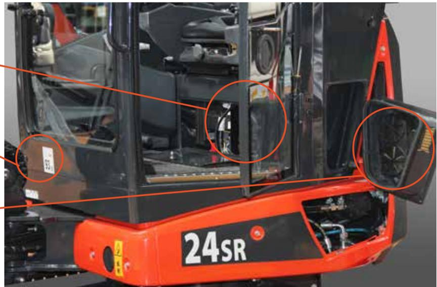
Die Aufnahme der Filter der Kabinenlüftung erlaubt eine umgehende Kontrolle und einen eventuellen Austausch derselben.
