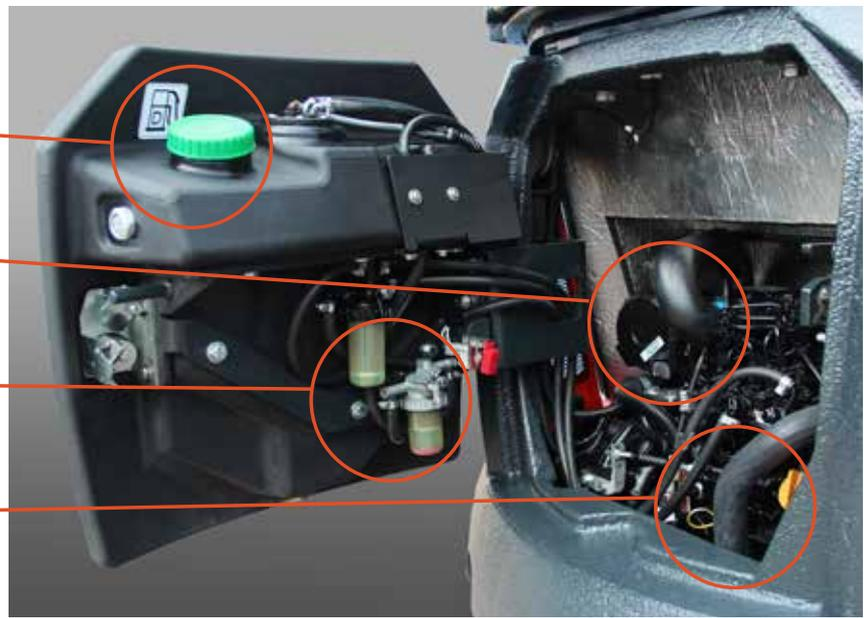
Die seitliche, zu öffnende Haube erleichtert die Kontrolle und die Reinigung der Kühler und des Hydraulikölfilters.
