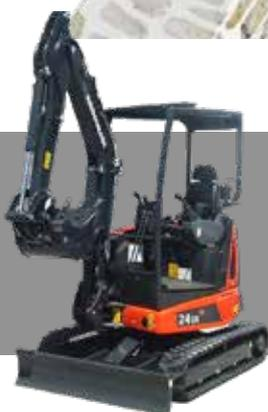
Beide Modelle können zum Schutz mit Überrollbügel.(Rollbar) mit 4 Trägerrahmen oder Kabine ausgestattet sein. Die Wahl erlaubt eine Vielseitigkeit ohne Gleichen: minimaler Platzbedarf bei Höchstleistungen.
