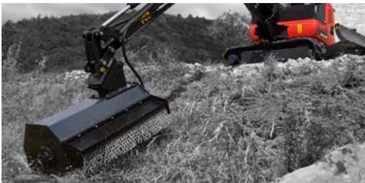
Hydraulikanlage für Mulcher mit zusätzlicher Pumpe (19 l/Min.)
